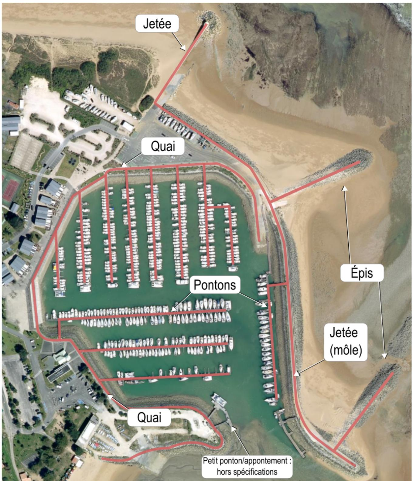
**Modélisation géométrique** : Les ouvrages de protection ou d'accostage sont modélisés suivant leur axe et leur sommet ou suivant leur rebord suivant le cas. Lorsqu'un ouvrage vertical ou subvertical borde une surface d'eau, cette dernière a une géométrie partiellement identique à la Construction linéaire.
