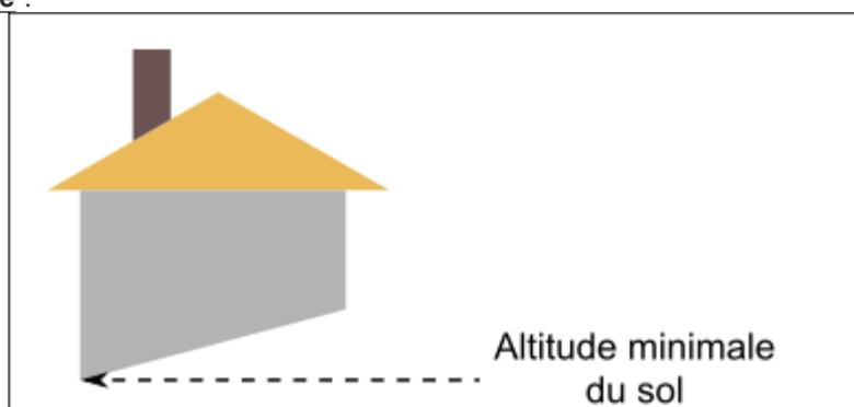
Point le plus bas du sol au pied du bâtiment. Cette valeur est calculée par Photogrammétrie ou par interpolation sur un MNT du RGE ALTI® obtenu par corrélation.
