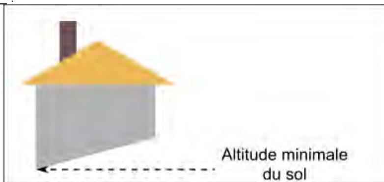
Point le plus bas du sol au pied du bâtiment. Cette valeur est calculée par Photogrammétrie ou par interpolation sur un MNT du RGE ALTI® obtenu par corrélation ou lidar.
