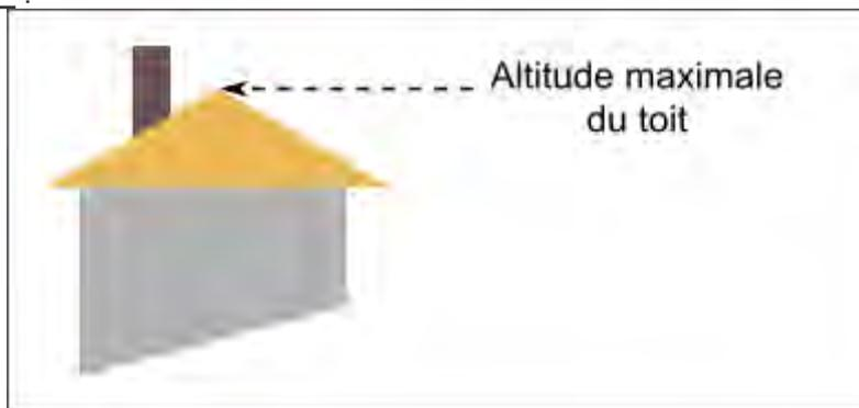
Cette altitude maximale correspond à l'altitude la plus élevée au faite du toit du bâtiment. Les éléments de construction, telles les cheminées ne sont pas prises en compte.
