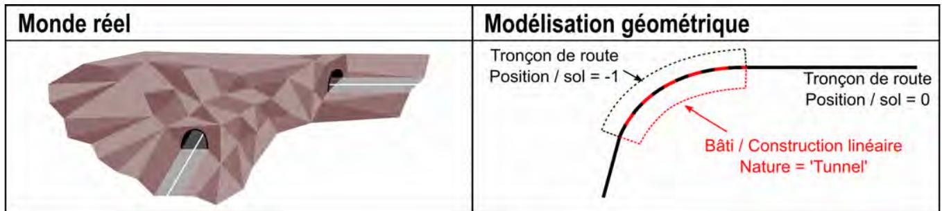
Un canal navigable passant dans un tunnel, est également doublé d'un objet de Nature="Tunnel".
