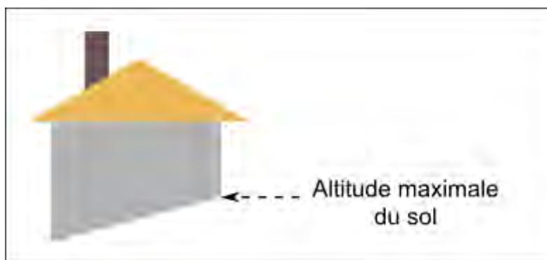
Cette altitude au sol correspond au point le plus haut, dans le cas d'un bâtiment construit sur un sol en pente.
