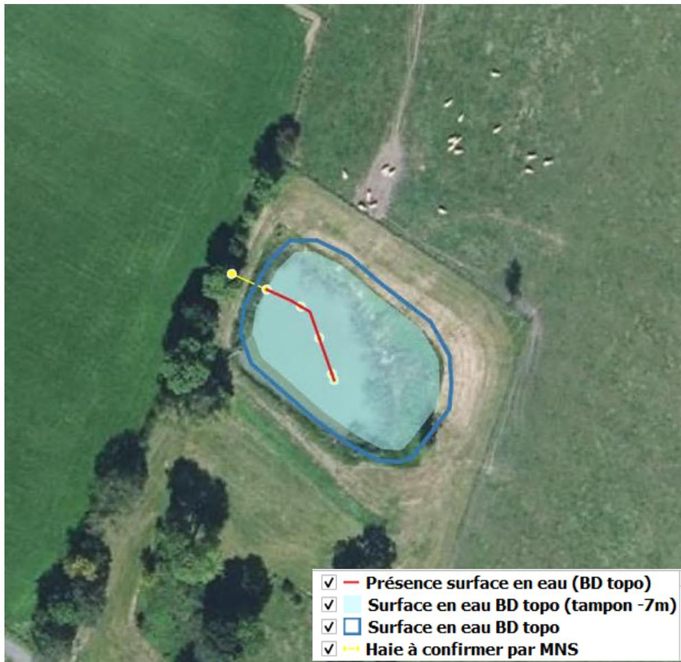
Figure 24 : exemple d'une haie remplacée par une surface en eau.
