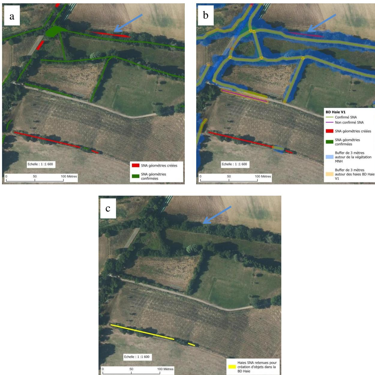
**Figure 26 : a : les géométries créées après comparaison des deux millésimes de SNA apparaissent en rouge. La géométrie indiquée par la flèche bleue est considérée comme un faux positif, b : la géométrie se situe à plus de 50% à l'intérieur de la zone de végétation autour d'une haie existante, c : la géométrie n'est pas retenue pour créer une nouvelle haie contrairement aux géométries situées au Sud de l'image**
