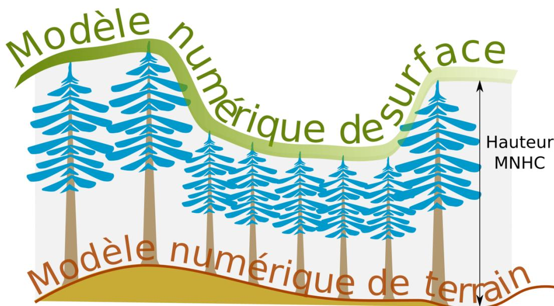
**Figure 4 : la différence entre le modèle numérique de surface obtenu par corrélation d'images et le modèle numérique de terrain permet d'obtenir le modèle numérique de hauteur (MNH) qui décrit la hauteur des arbres et des autres éléments du sursol**
