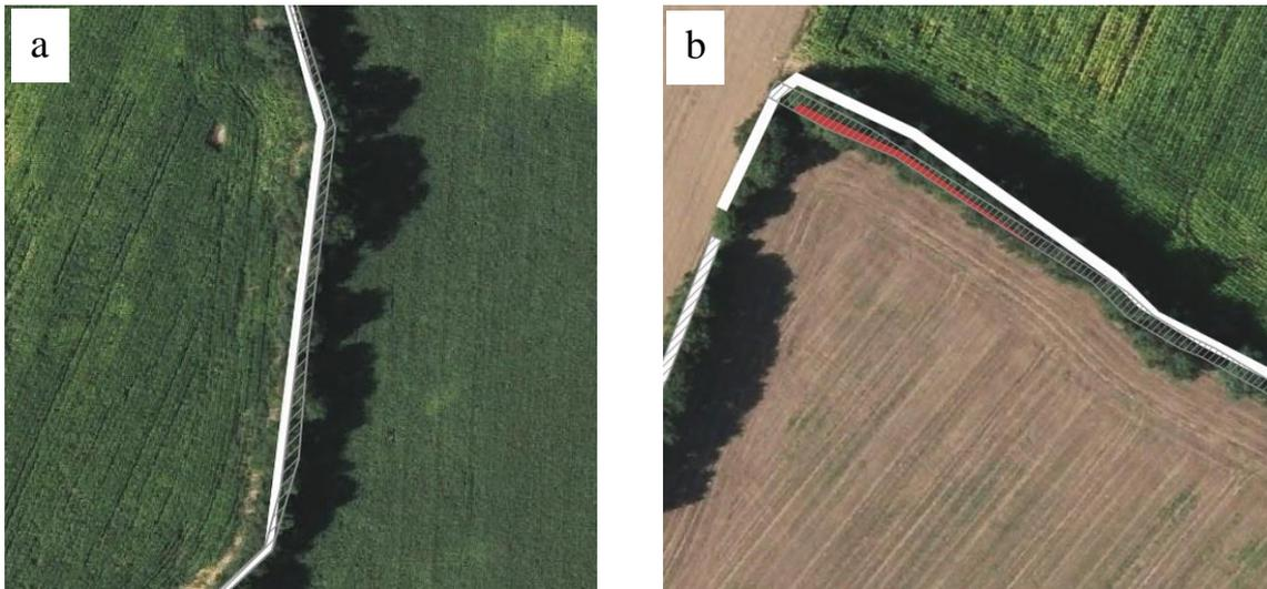
**Figure 13 : a : la géométrie de la SNA récente est entièrement située à moins de 3 mètres de la géométrie de la SNA de 2015. Les deux objets sont considérés comme identiques. b : une partie de la SNA récente est située à plus de 3 mètres de la SNA de 2015, cela conduit à l'identification erronée d'une géométrie créée (en rouge)**
